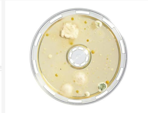
**Filtracija zraka** – mikrobiološka kontrola kakvoće zraka sa želatinoznim filterima i BACTair pločama
